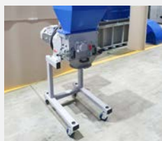
OPTION Hohes Fahrgestell mit Adapter zur Abfüllung des Mahlgutes in handelsübliche Säcke
